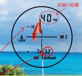
★★★ 傾斜切替スイッチをスライドすると液晶画面に「M3」が表示されます。「M3」表示を確認後、目標(ピン)までの間に障害物がない状態で計測をして下さい。 ※モード表示が「M1」「M2」の場合はモードボタンを押して変更して下さい。 25
